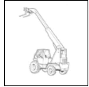
Figura 8. Carretilla elevadora de alcance variable.
