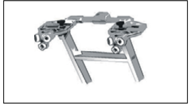
Figura 36. Ejemplo de dispositivo para el apoyo de una escalera simple sobre ambos largueros
