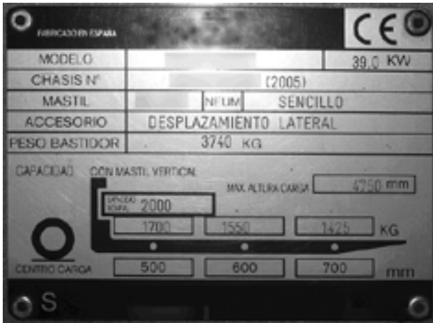
Figura 14. Ejemplo de placa de cargas y alcances de una carretilla elevadora de horquilla
