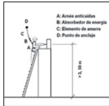
Figura 49. Ejemplo de utilización de un sistema anticaídas en una escalera de mano
