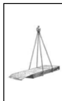
Figura P14. Carga "abrazada" con eslingas demasiado largas. La carga se puede deslizar
