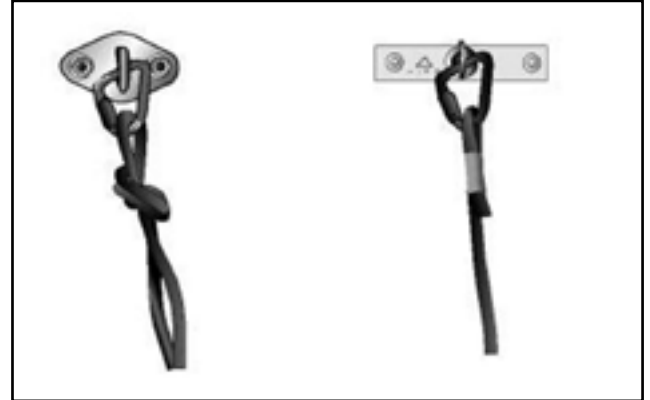
Figura 65. Anclajes de las cuerdas de seguridad y de trabajo independientes
