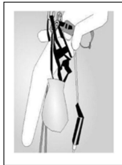
Figura 70. Herramientas u otros accesorios unidos al arnés o al asiento mediante conectores y cordinos
