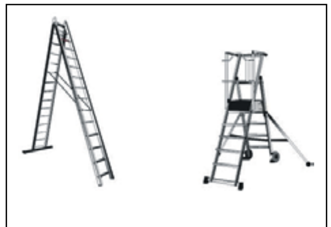
Figura 38. Ejemplos de escaleras con estabilizadores
