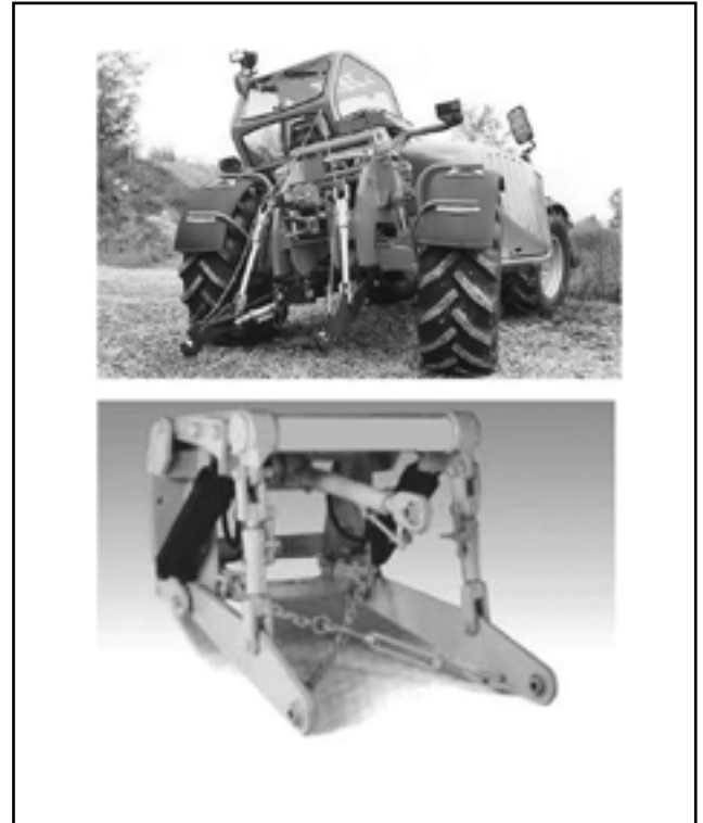
Figura 10. Sistema de enganche en tres puntos
