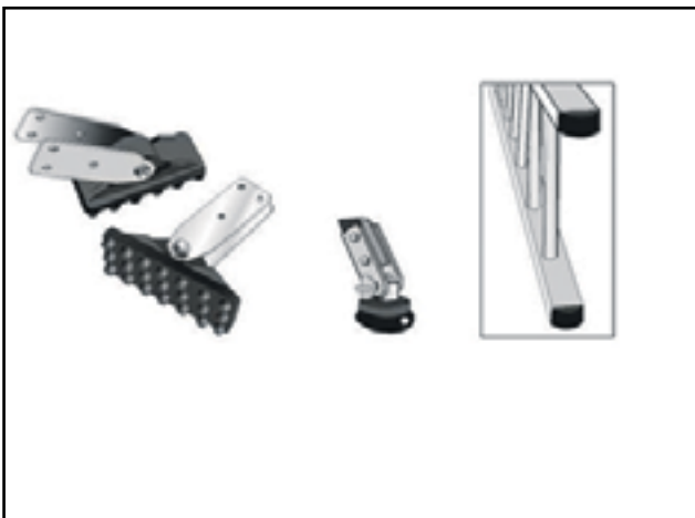
Figura 41. Inmovilización de la parte inferior de una escalera de mano mediante zapatas
