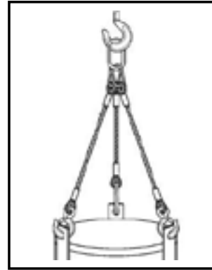
Figura P9. Los puntos de enganche al equipo de elevación y de presión de la carga aseguran un reparto equilibrado de la carga
