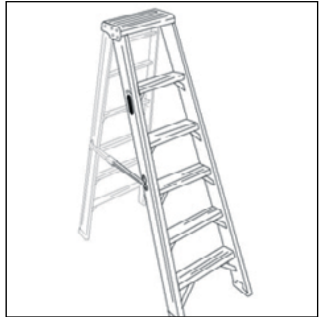
Figura 34. Escalera de tijera con sistema rígido para impedir su apertura por deslizamiento
