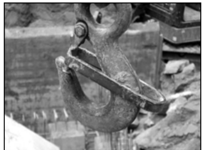
Figura 22. Ejemplo de gancho inseguro
