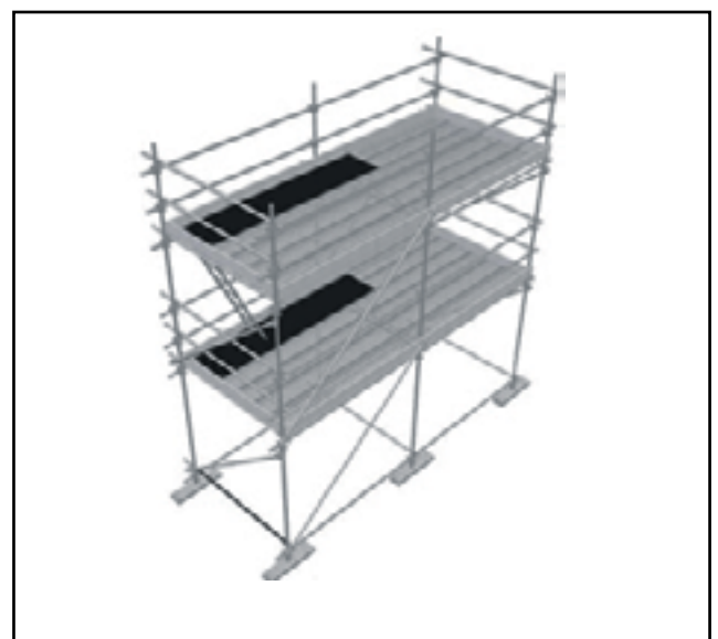
Figura 53. Ejemplo de andamio metálico tubular no modular
