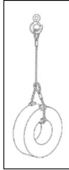
Figura P1. Carga simétrica con eslingas de nudo corredizo (carga ahorcada). Carga estable
