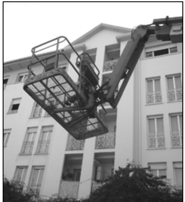
Figura 23. Habitáculo unido permanentemente al equipo de trabajo (PEMP)
