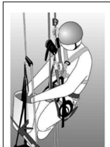
Figura 71. Utilización de una tercera cuerda auxiliar
