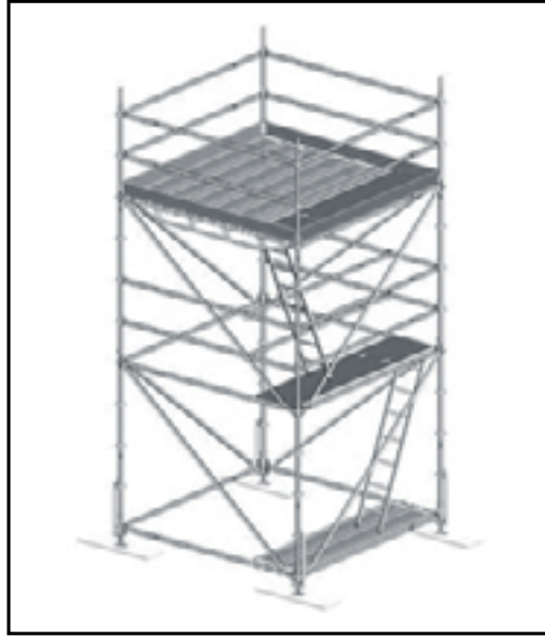
Figura 55. Torre de trabajo fija
