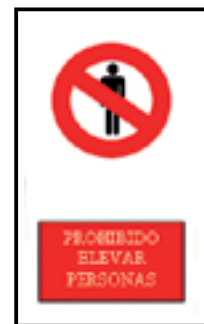
Figura 16. Ejemplo de señal de prohibición de elevar personas
